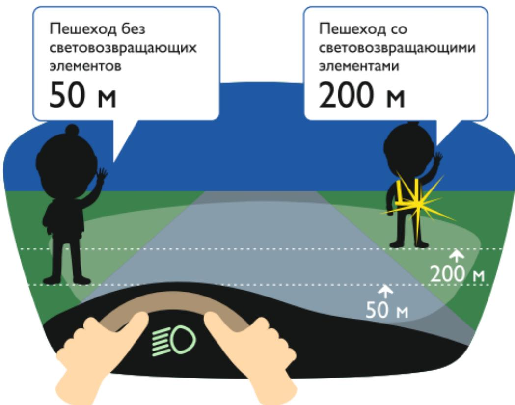
При движении с ближним светом фар водитель автомобиля способен увидеть пешехода на дороге на расстоянии 25-50 метров. Если пешеход применяет световозвращатель, то это расстояние увеличивается до 150-200 метров. А при движении автомобиля с дальним светом фар дистанция, на которой пешеход становится виден, с применением световозвращателей увеличивается со 100 метров до 350 метров. Это даёт водителю 15-25 секунд для принятия решения.
